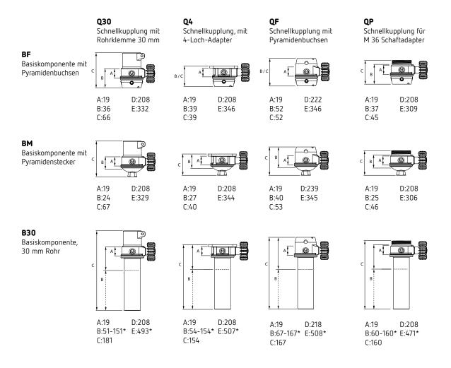
**A** Funktionelle Höhe in mm **B** Effektive Höhe in mm **C** Gesamthöhe in mm **D** Effektives Gewicht in g **E** Gesamtgewicht in g \*B30: Effektive Höhe und effektives Gewicht variieren, da das Rohr um bis zu 100 mm gekürzt werden kann.
